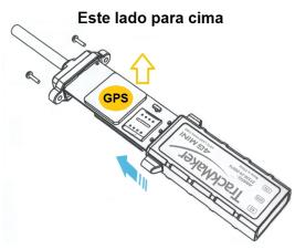
O módulo deve ser instalado com a antena GPS posicionada para cima, direcionada para o céu. Não instale o módulo debaixo de superfícies metálicas ou debaixo de vidros com películas reflexivas (espelhadas).
